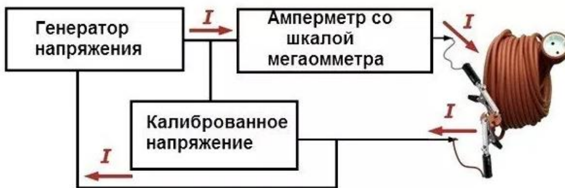
Рисунок 8 - Структурная схема мегаомметра
